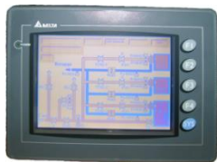
Пример блока управления и индикации (БУИ) на графическом дисплее с мнемосхемой.
